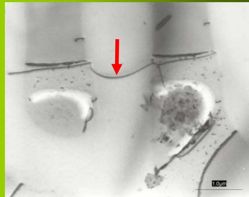
Pipeline – Defekt verbindet zwei Zellknoten
