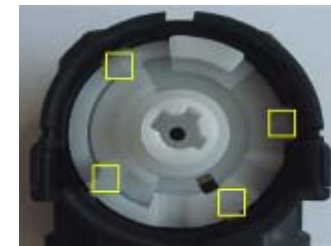
Schritt 2: Gezielte Kontamination mit Öl
